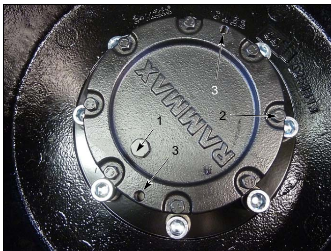
Rys. 8-1 Wymiana oleju przekładniowego
