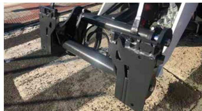
Adapter Quick-Tach™ to – Bob-Tach™ (wymagany do wszystkich modeli osprzętu poza łyżkami i widłami paletowymi)
