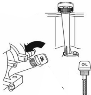
Rys. 2 Sprawdzenie poziomu oleju silniki HONDA i MITSUBISHI (jednocylindrowe)
